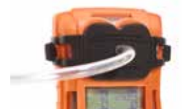
Adattatore di calibrazione/bump test Per applicare il gas da testare al T4
